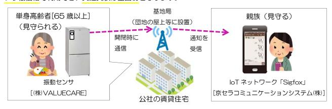
この実証実験は、単身高齢者宅(65歳以上)の冷蔵庫ドア等(1日1回は開け閉めを行う場所)に振動 を感知するセンサを取り付け、開閉時に送信される信号をコミュニケーションアプリの LINE やメール で通知し、離れて暮らす親族が長時間使用がない等の異変を確認できる仕組みです。サービスの商品化 をめざし、通信環境や使い勝手等を試していただくモニターを公社の賃貸住宅の入居者から募り、8月 から4か月間の実証実験を行います。
